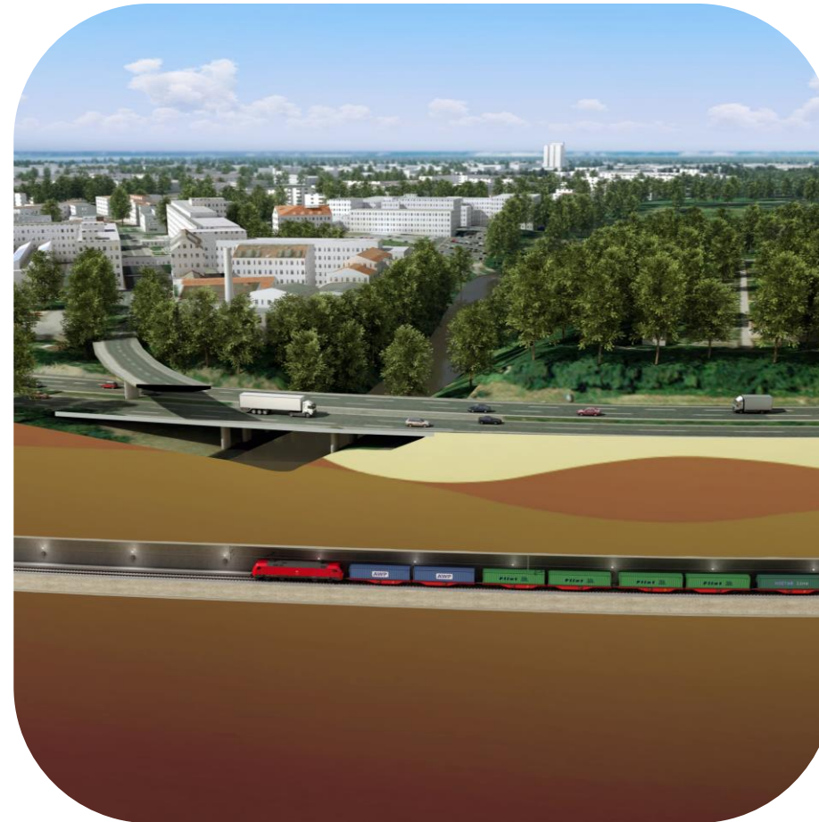
Auf Höhe der Autobahn A73 unterquert der Tunnel die Pegnitz und erreicht dort seinen tiefsten Punkt (DB AG).
