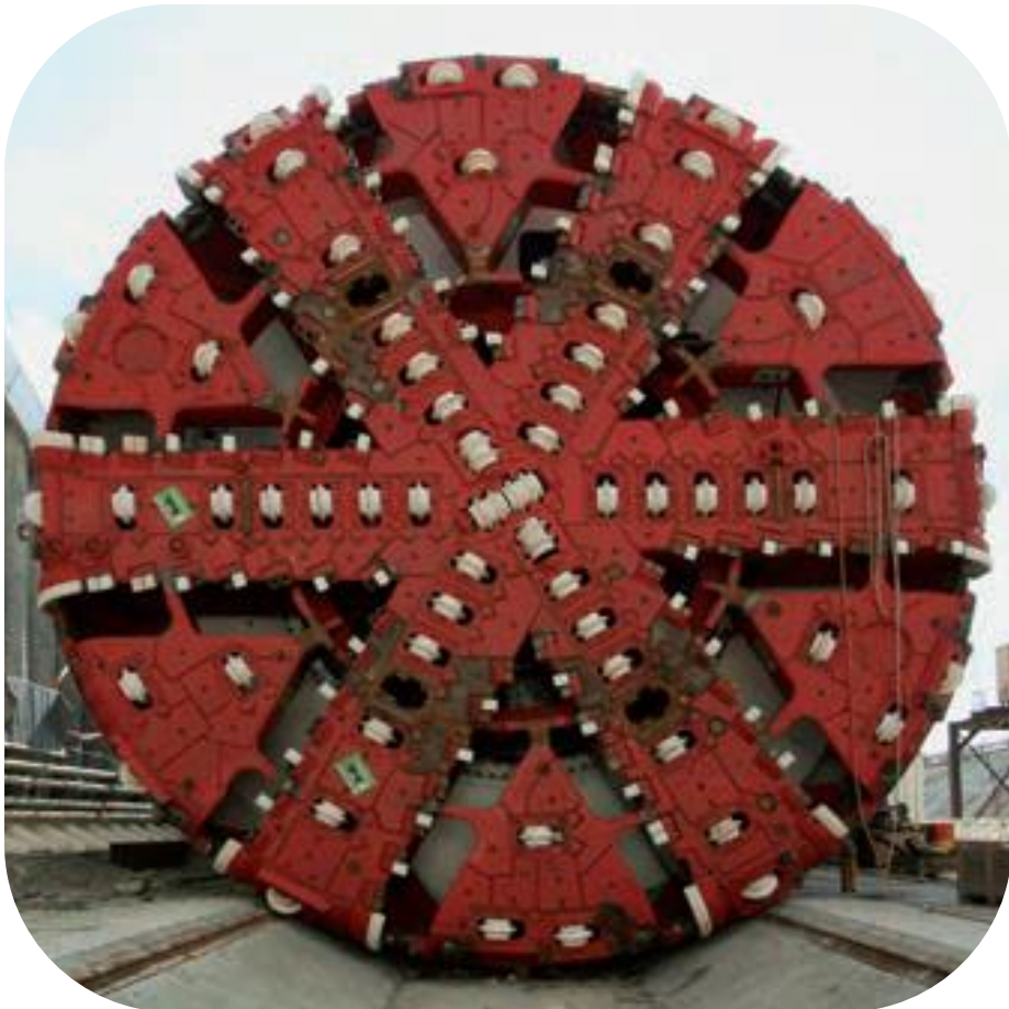
Schneidrad einer Tunnelvortriebsmaschine (DB AG)
